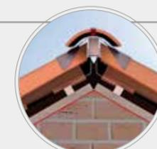
Sobre el rastrel de cumbre se colocará el Bajo-Cumbrera (Mixto, Aluminio o Rígido), fijándolo con grapas o clavos. Los rollos disponen de bandas de adhesivo butílico para fijarse sobre el perfil de las tejas e impermeabilizar la unión. Finalmente se instalarán los Caballetes y Tapones Laterales, fijándolos con tornillos, clavos o Ganchos de Caballete
