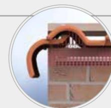
Los remates laterales (izquierdos y derechos) se instalarán siguiendo el paso de la teja, quedando los laterales por debajo de la teja. Para finalizar el faldón en el lado derecho se rematará sobre el lateral con la media teja o la teja y media, dependiendo de la anchura del faldón.
