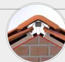
Sobre el rastrel de cumbre se colocará el Bajo-Cumbrera (Mixto, Aluminio o Rígido), fijándolo con grapas o clavos. Los rollos disponen de bandas de adhesivo butílico para fijarse sobre el perfil de las tejas e impermeabilizar la unión.
