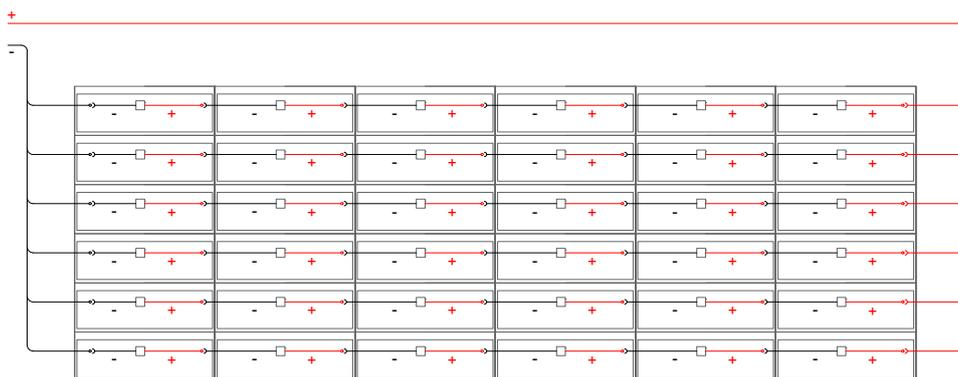
Schéma de câblage du système avec les Tuiles SOLAR Flat-10
